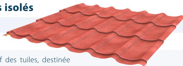
La tuile 24-183-1100 est une plaque emboutie au motif des tuiles, destinée aux couvertures sèches et surcouvertures de pente courante 25% à 50%. Elle est une alternative aux tuiles classiques pour les nouvelles constructions, mais peut aussi servir pour la rénovation de vieilles toitures. La laque définie à la commande de JI 24-183-1100 Panneau-tuile est appliquée en face A. Nous consulter à la commande pour connaissance de la méthode de calepinage.
